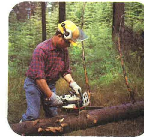
I dette AV-håndtaket sitter også sperren for gashendelen. Den gjør ønsket rusing av sagen umulig, for gass kan bare gis når sperren er trykket ned.
